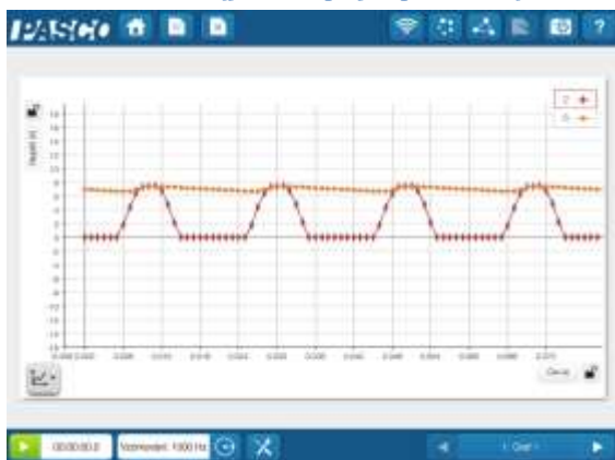
Usměrnění střídavého napětí pomocí senzorů Pasco
